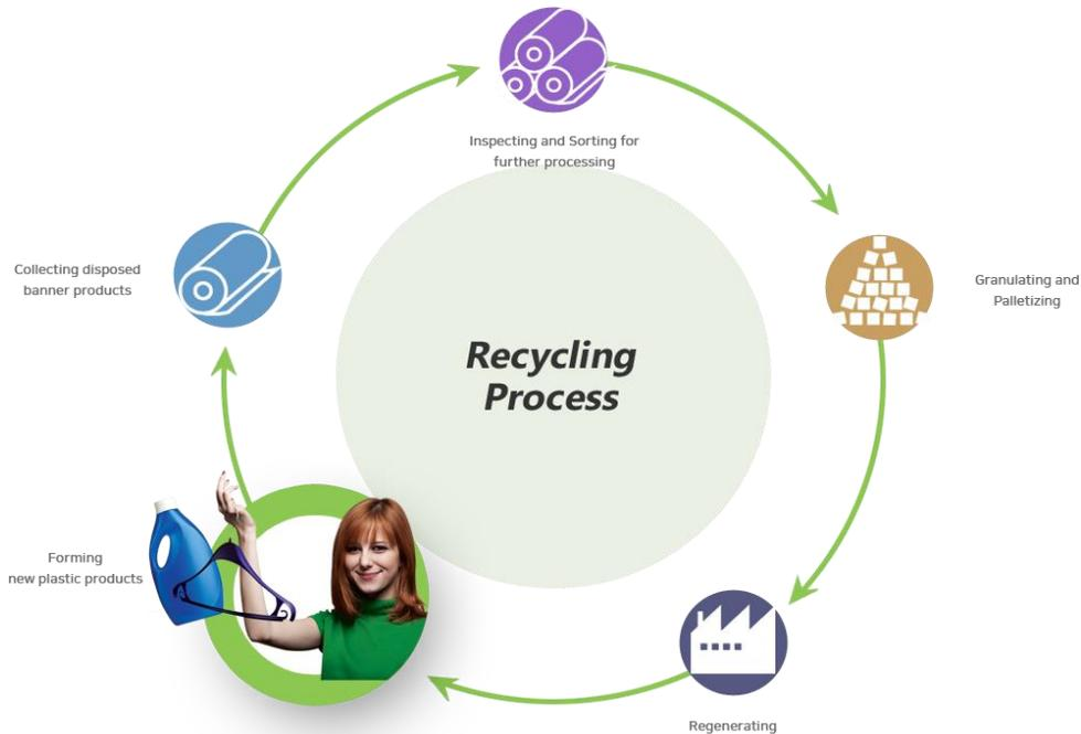
INNOGREEN은 PVC-free Sign Media로 상지와 하지 직물 모두 TPO 폴리올레핀 계열로 되어 있습니다. PVC와 폴리에스터 직물이 혼합된 제품은 환경호르몬 발생 등의 문제로 매립 외에는 폐기가 불가하여 재활용에 어려움을 가지고 있습니다. 반면, 폴리올레핀 계열 소재의 원단은 표면의 극성이 존재하지 않아 Digital Printer와의 호환성 및 인쇄성이 떨어지게 됩니다. 원풍은 이러한 PVC와 폴리올레핀 계열 소재의 단점을 각각 보완하여, 인쇄성이 우수하면서도 재활용이 가능한 INNOGREEN Sign Media 제품을 개발하였습니다.
